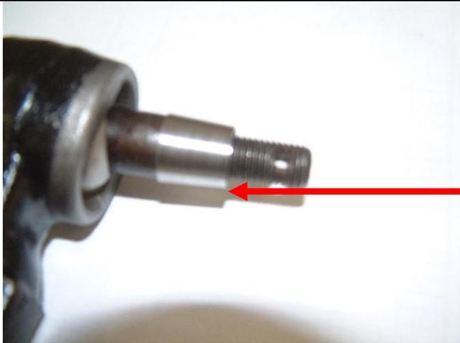
THE SUPPLIED TIE-ROD END SHOULD HAVE THE INSERT PLACED ON THE SHAFT AS SHOWN
